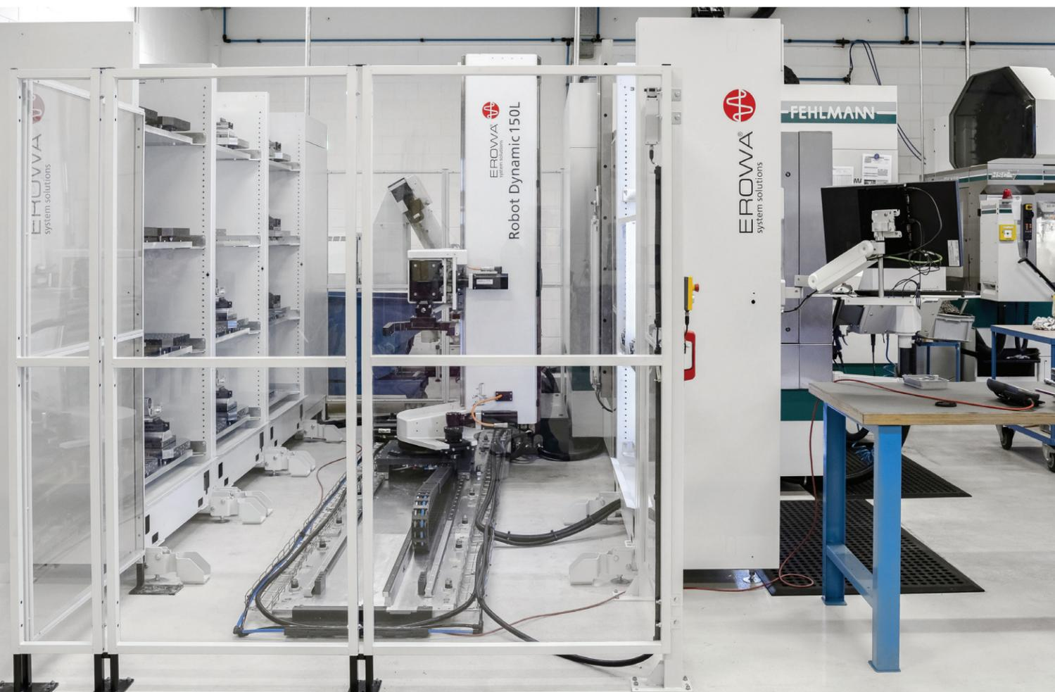
„Auf der Fertigungszelle lassen sich die für uns typischen Serien von 20 bis 30 Stück effizient fertigen. Durchschnittlich bearbeiten wir zwei bis drei Jobs pro Tag“, erläutert Reto Helfenstein. Auf dem Maschinentisch der Versa bildet ein EROWA UPC Spannutter die präzise Basis für schnellen und positioniergenauen Wechsel der palettierten Werkstücke. Mit der Palettengrösse von 320 x 320 mm ist dies die ideale Aufspannfläche für die diversen Spannvorrichtungen oder Werkstücke“.
