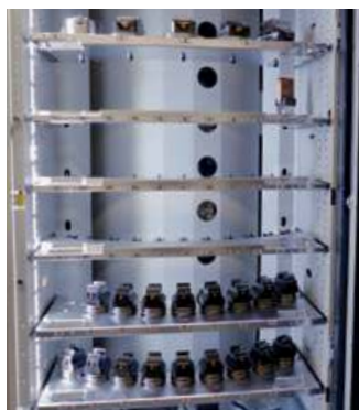
Un petit défi pour FEHLMANN : des palettes UPC 320 x 320, ITS 85 et 148 ainsi que des porte-électrodes sont utilisés.
