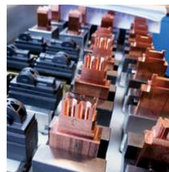
Les deux centres d'usinage sont exploités à 30% pour le fraisage d'électrodes en cuivre. Indépendamment de cela, des électrodes graphite sont également produites chez WESKO, certes sur une autre machine.
