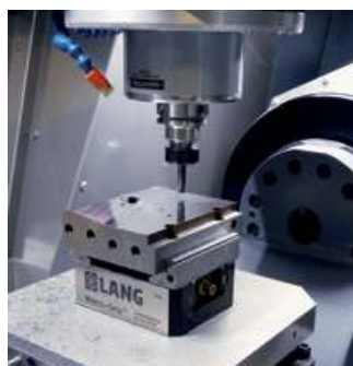
Avec les transmissions linéaires, nous profitons non seulement d'une avance plus rapide et d'une excellente dynamique mais aussi d'une grande précision dans les angles. Des tolérances de 1/100 mm sont ainsi garanties sur le long terme.
