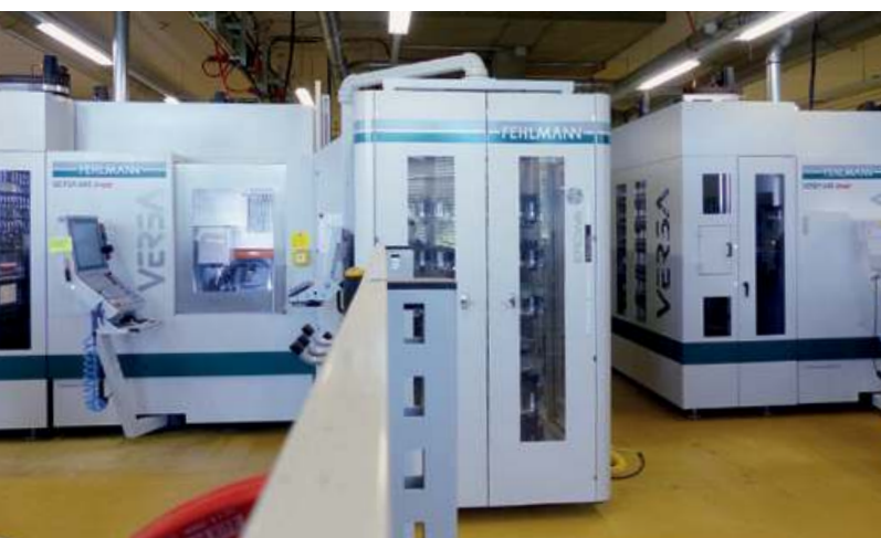
En 2018 l'entreprise investit dans un premier centre d'usinage 5 axes VERSA 645 linear, suivi en 2019 par le deuxième. Les deux installations sont reliées par un robot Multi (ERM) d'Erowa.
