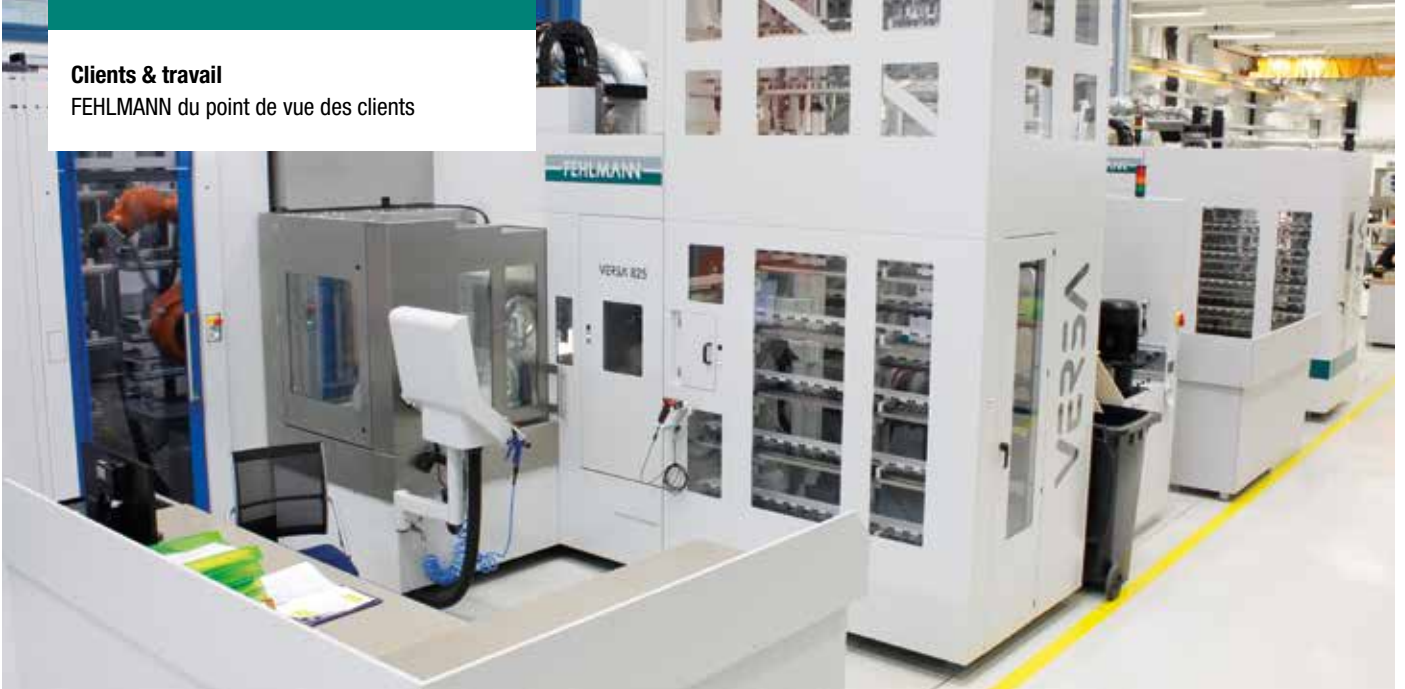
Les éléments essentiels de la solution d'automatisation de Test-Fuchs sont la FEHLMANN VERSA 825 et le magasin d'outils avec 346 outils.
