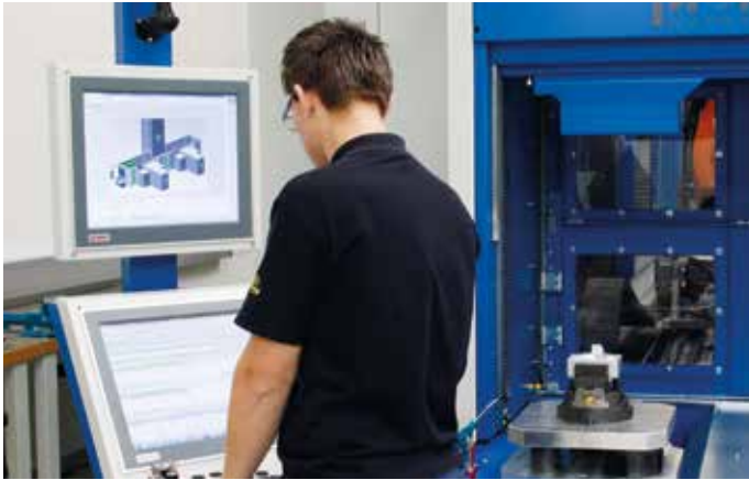
La cellule d'automatisation avec système à rail, station de chargement/déchargement, robot et ordinateur central a été fournie par Promot Automation.
