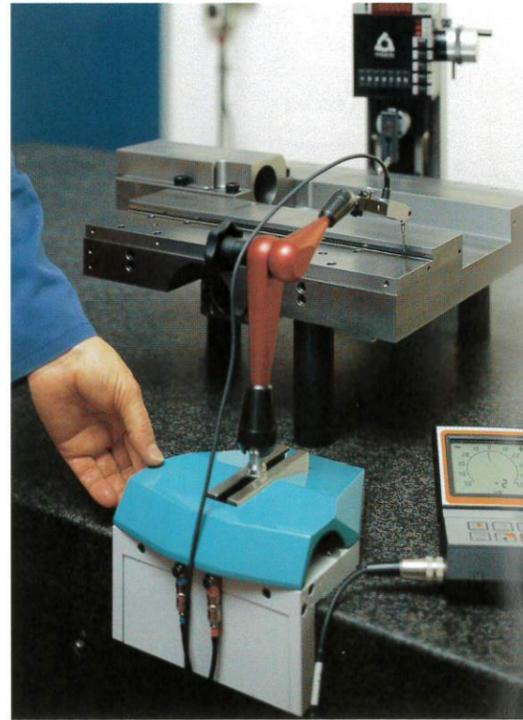
L'appareil de mesure „Straighline“ permet la mesure d'angle et de planéité avec la plus grande précision.
